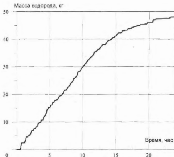
Рис. 8. Генерация водорода в УЛР при взаимодействии расплава с бетоном для аварии с большой течью Ду850 на ЛАЭС-2
