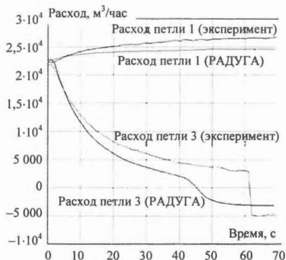
Рис. 6. Изменение расходов теплоносителя в петлях 1 и 3 по данным СВРК и рассчитанное по программному комплексу РАДУГА-7.5 в переходном процессе, обусловленном отключением ГЦН №№ 3, 4 из четырех работающих
