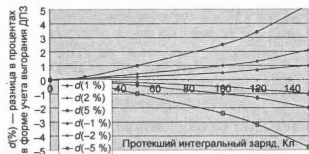
Рис. 3. Погрешность учета выгорания ДПЗ для случая разброса начальной чувствительности \pm 1, \pm 2, \pm 5\% в зависимости от протекшего заряда: d(a\%) – отклонение в процентах в значении формулы (10) при отклонении начальной чувствительности ДПЗ на a\%
