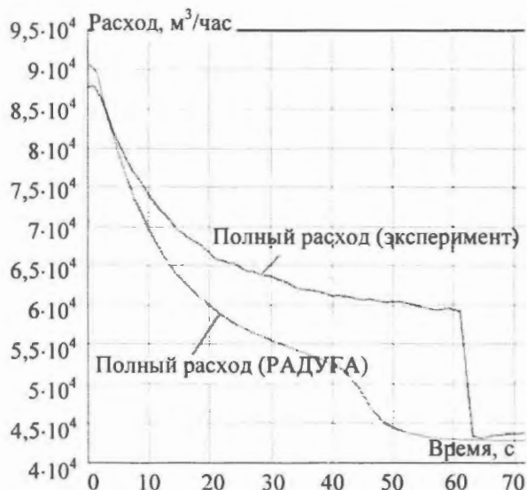
Рис. 7. Изменение полных расходов теплоносителя через реактор по данным СВРК и рассчитанное по программному комплексу РАДУГА-7.5 в переходном процессе, обусловленном отключением ГЦН №№ 3, 4 из четырех работающих
