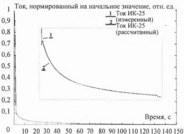
Рис. 7. Изменение рассчитанных и измеренных токов ИК в процессе сброса АЗ с застреванием стержня 6-й группы (координаты 11-38) и последующим его добросом на 42-й с
