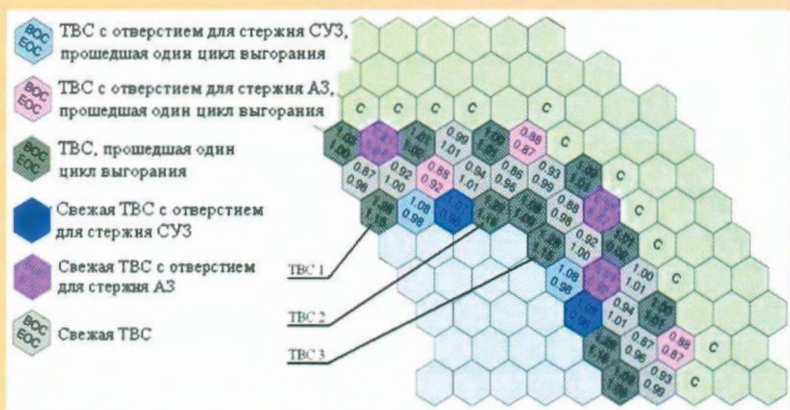
Рис. 3. Покассетное энерговыделение в реакторе NGNP для варианта с двухкратной перегрузкой: БОС – значение энерговыделения в начале цикла, отн. ед.; ЕОС – значение энерговыделения в конце цикла, отн. ед.
