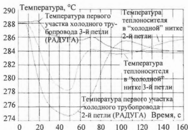
Рис. 9. Изменение во времени температуры теплоносителя в "холодных" нитках петель I контура по термосопротивлениям в переходном процессе, обусловленном отключением ГЦН №№ 3, 4 из четырех работающих
