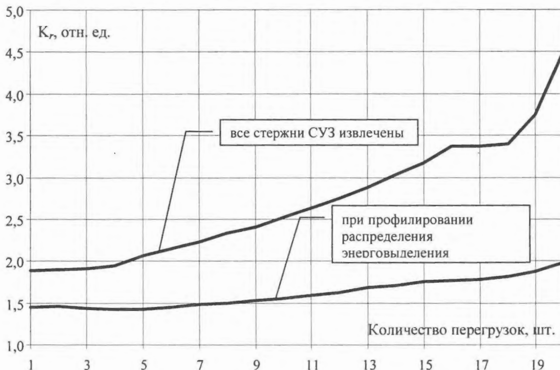
Рис. 7. Изменение коэффициента радиальной неравномерности распределения энерговыделения в “рабочем” состоянии реактора
