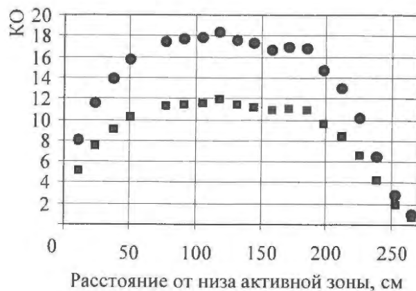
Рис. 11. Распределение КО по контейнерам гирлянд ОС для КР с КЭ (а) и с полной активной зоной (б): ● – КО для сварного шва № 4, ■ – КО для основного металла
