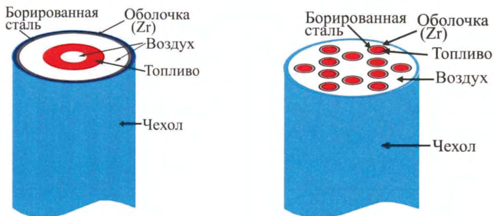
Рис. 13. Распределенный источник ОТВС в уточненной \langle R-Z \rangle и 3D геометрии для расчетов мощности дозы
