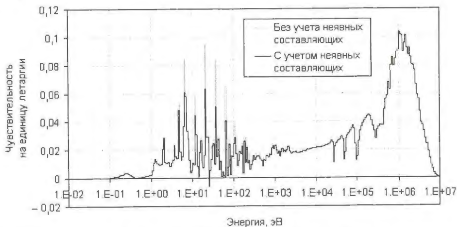
Рис. 2. Энергетический профиль чувствительности k_{эф} к сечению рассеяния водорода для 2-й расчетной модели (50 % ^{235}\text{U} )
