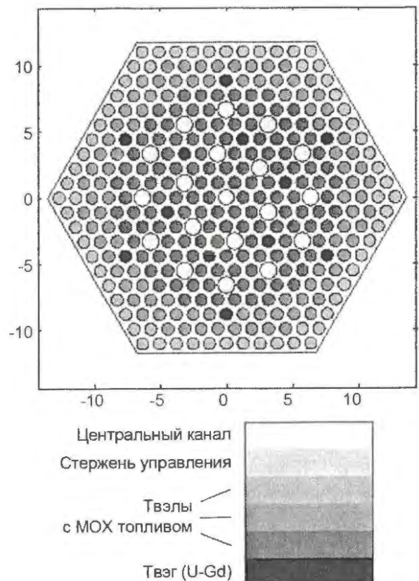
Рис. 12. Картограмма ТВС с MOX топливом
