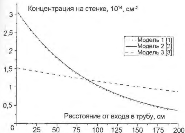
Рис. 4. Сравнение расчёта концентрации для разных моделей при одинаковых параметрах системы, время испытания 10 часов
