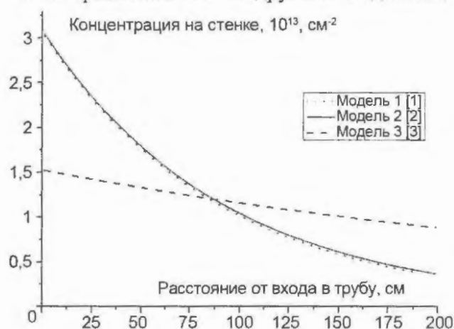
Рис. 3. Сравнение расчёта концентрации для разных моделей при одинаковых параметрах системы, время испытания 1 час
