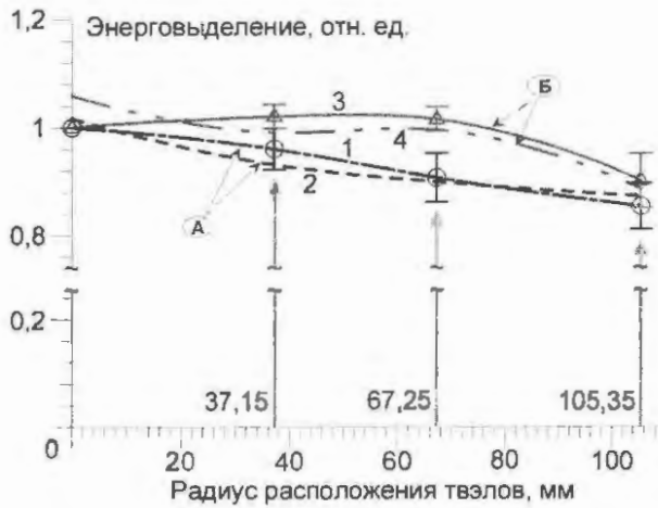
Рис. 5. Распределение энерговыделения в твэлах по радиусу а.з. критической сборки стенда НАРЦИСС. В конфигурации А: кривая 1 (— · — · —) — сплайн измеренных точек (O), кривая 2 (— — —) — результаты расчётов. В конфигурации Б: кривая 3 (—) — сплайн измеренных точек (Δ), кривая 4 (— · — · —) — результаты расчётов
