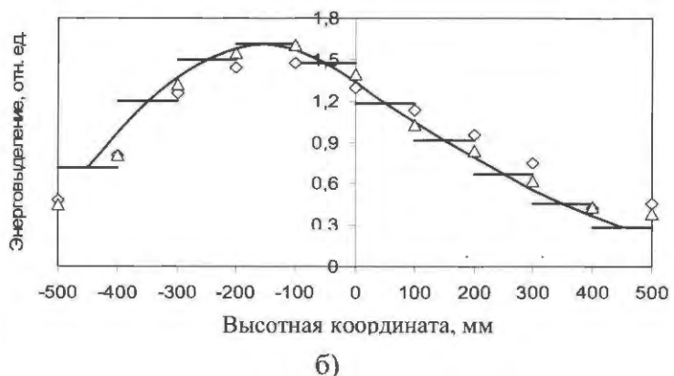
Рис. 8. Распределения энерговыведения в ПТВС в состоянии 3) (обозначение см. на рис. 6): а) – потвзльное (интервал отклонений \pm 3\% ); б) – высотное (среднеквадратическое отклонение 9\% )
