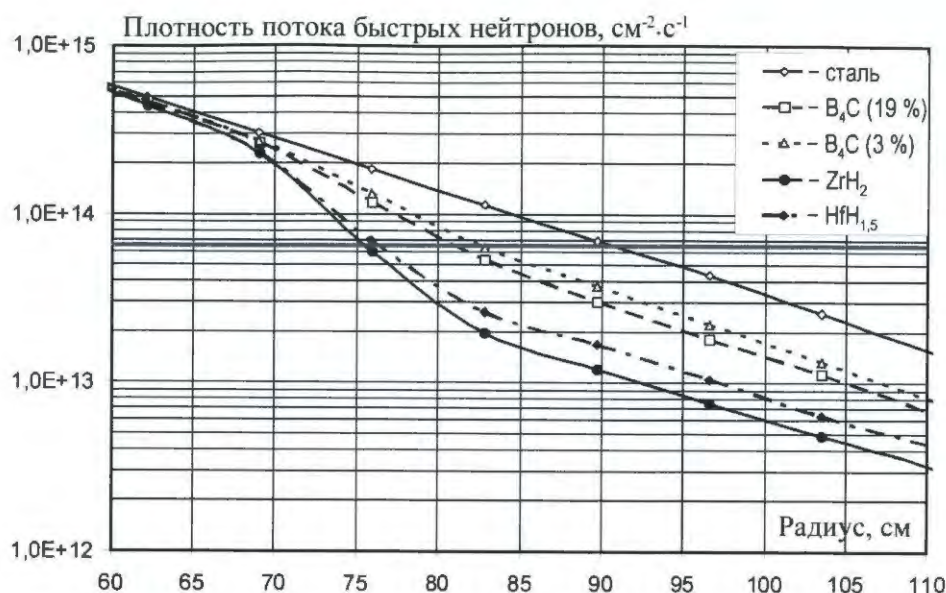
Рис. 2. Радиальное распределение плотности потока быстрых нейтронов в БЭ МБИР (— — допустимое значение плотности потока быстрых нейтронов на внутренней стенке корпуса реактора)
