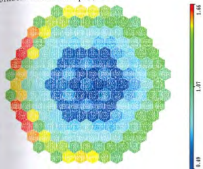
Рис. 4. Распределение числа делений по ТВС при сдвиге а.з. относительно выгородки вправо
