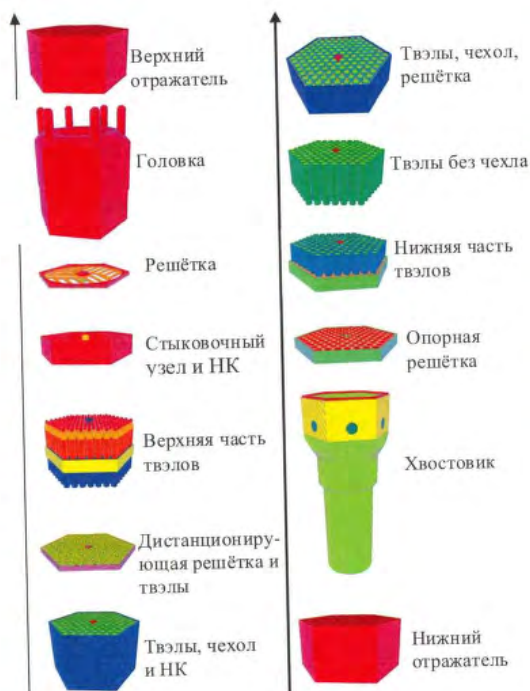
Рис. 2. Основные элементы модели топливной сборки РК-2 (масштаб не соблюден): НК – направляющий канал
