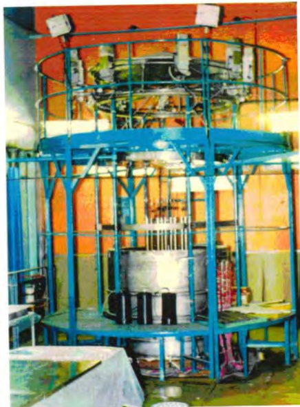
Рис. 1. Общий вид критического стенда АКСАМИТ
