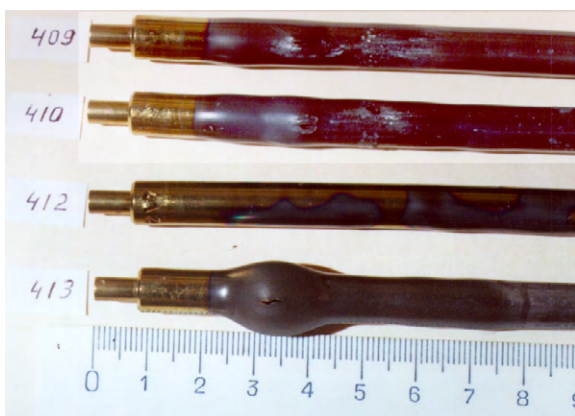
Рис. 13. Образцы свежего топлива ВВЭР после облучения
