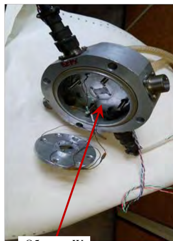
Рис. 4. Мишенный узел для облучения образцов W на циклотроне НИЦ «Курчатовский институт»
