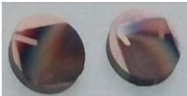
Рис. 5. Образцы вольфрама Plansee после облучения на циклотроне ионами азота N^{3+} энергией 28 МэВ, 10^{17} N^{3+}/см^2
