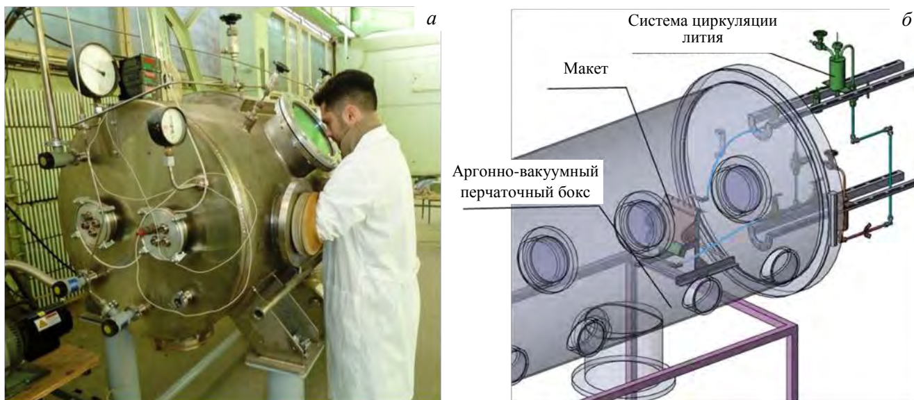
Рис. 4. Универсальный бокс для испытания диверторной мишени: а — внешний вид бокса (режим работы в инертной атмосфере); б — расположение макета диверторной мишени с литевой системой в привязке к универсальному боксу
