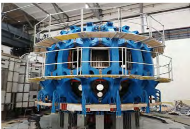
Рис. 1. Сооружение установки Т-15МД в экспериментальном зале
