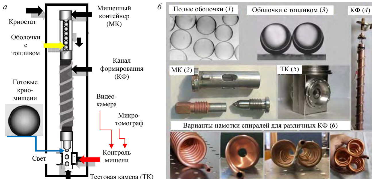
Рис. 1. Модуль формирования (МФ) для поточного производства криогенных топливных мишеней по методу FST (FST-MФ): а — функциональная схема FST-MФ; б — основные элементы FST-MФ
