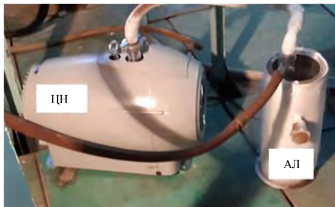
Рис. 8. Общий вид контура циркуляции гелия. На переднем плане шланг входа, на заднем плане шланг выхода в разрядную камеру
