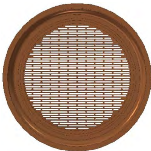
Рис. 5. Расположение щелей в начальном варианте плазменного электрода
