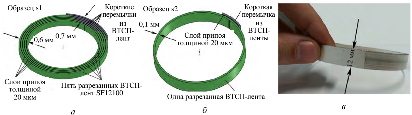
Рис. 1. Экспериментальные образцы: а — s1 (пять лент); б — образец s2 (одна лента); в — фото готового образца s1
