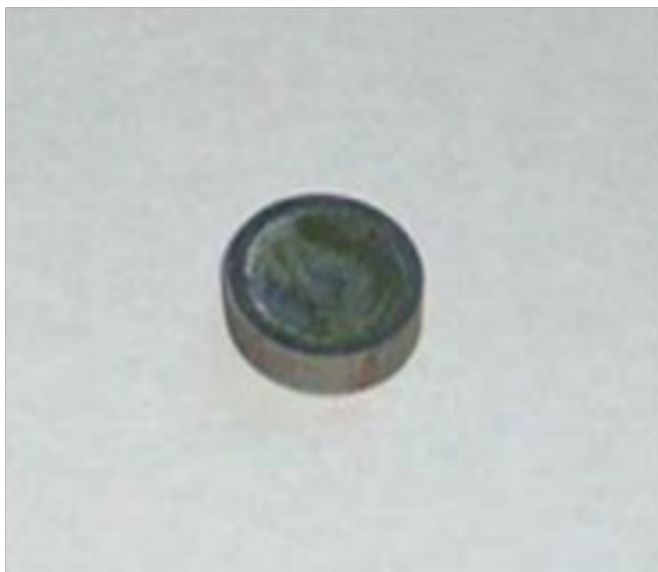
Рис. 5. Образец вольфрама PLANSEE после облучения протонами на циклотроне ( E_{p\text{ ср}} = 3,7 МэВ, 10^{18} р/см 2 )
