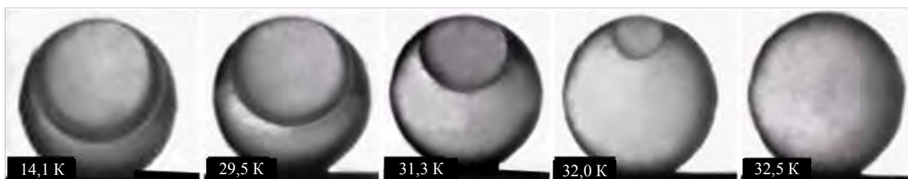
Рис. 10. Поведение границы раздела «жидкость—пар» при нагреве оболочки для случая \Theta > 1 ( \Theta = 1,4 , P_f = 850 атм., последний кадр — в оболочке жидкий водород)
