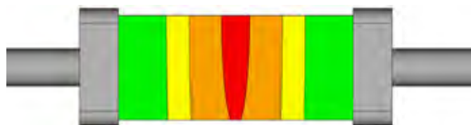
Рис. 17. Распределение плотности мощности пучка на пластине
