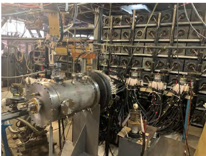
Рис. 1. Общий вид установки: на переднем плане вакуумная камера, далее правее виден ряд разрядников и конденсаторы
