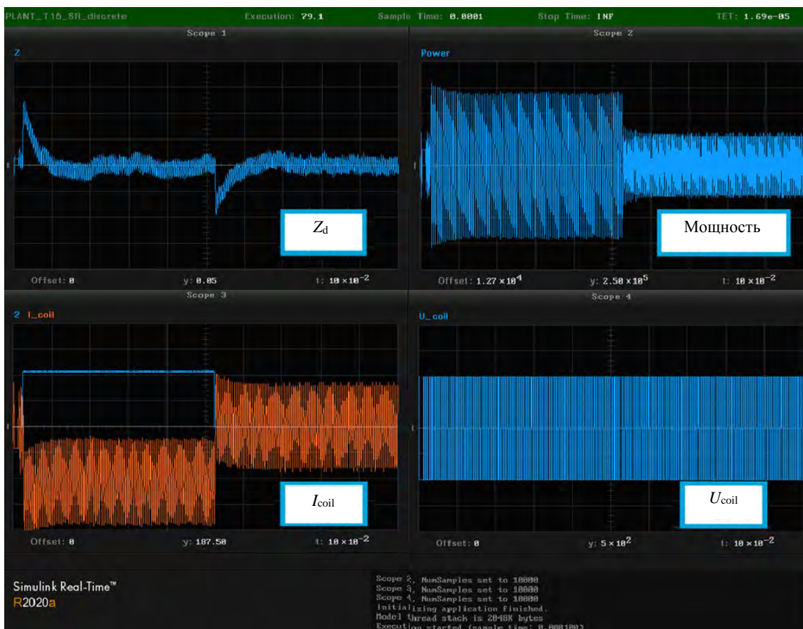
Рис. 12. Цифровые сигналы реального времени: переходные процессы в автоколебательной системе при действии ступенчатого внешнего возмущения w , когда Z_{ref} = 0 , на цифровой модели системы управления вертикальным положением плазмы. Мощность U_{coil} I_{coil}
