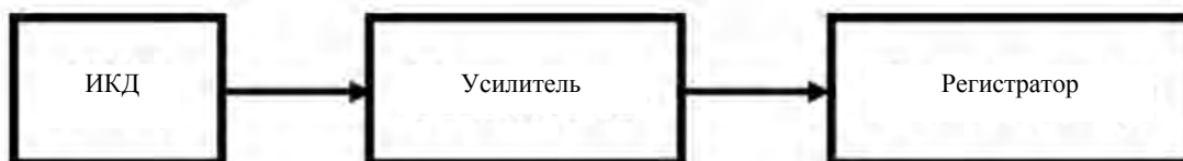
Рис. 1. Схема экспериментальной проверки метода калибровки флуктуационного канала нейтронной диагностики плазмы
