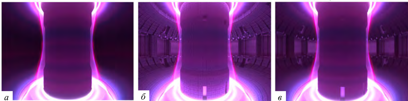
Рис. 7. Визуализация свечения пристеночного слоя плазмы в режиме с P_{SOL} = 10 \text{ МВт} и n_e^{sep} = 2,55 \cdot 10^{19} \text{ м}^{-3} для стенки, полностью поглощающей свет (а), новой стенки (б) и экспонированной стенки (в)
