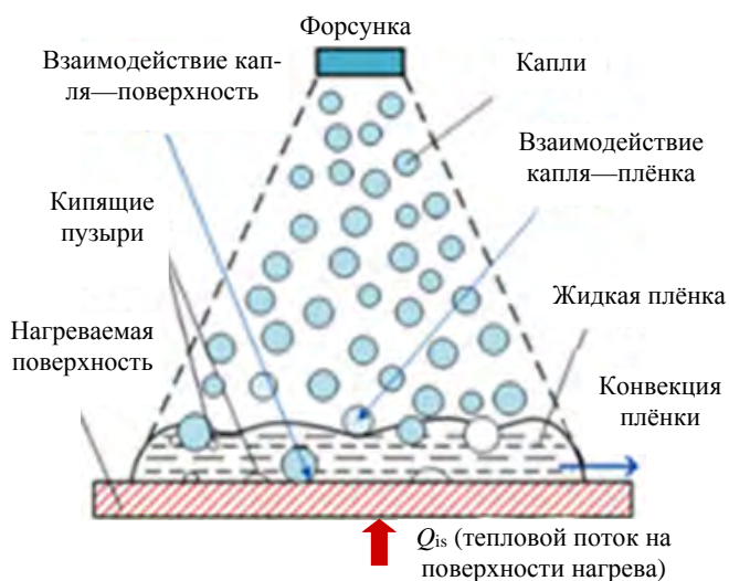
Рис. 1. Процесс теплопередачи при распылительном охлаждении
