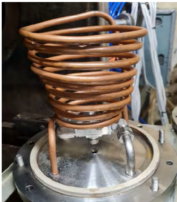
Рис. 5. Фотография нижнего фланца с установленным конденсатором и форсункой
