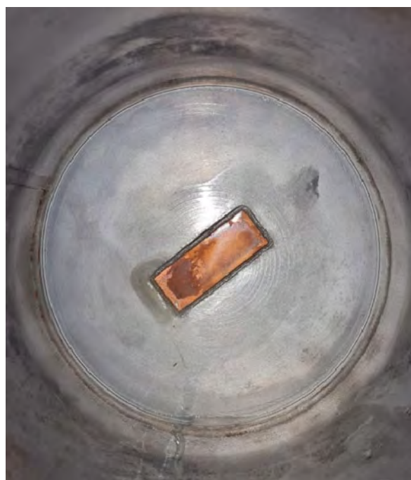
Рис. 6. Фотография внутренней поверхности верхнего фланца с мишенью после проведения первых серий экспериментов
