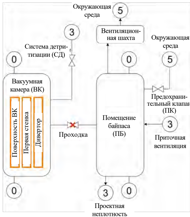
Рис. 3. Нодализационная схема ИТЭР для анализа аварии LOVA [18] по СОКРАТ, граничные условия: 0 — «непроницаемая стенка»; 3 — «расход»; 5 — «давление»
