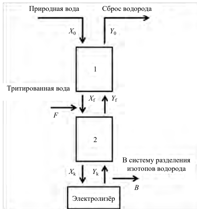
Рис. 11. Схема системы переработки жидких тритийсодержащих отходов, использованная авторами при расчётах
