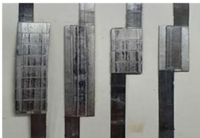
Рис. 1. Пример КС двух ВТСП-2-лент с помощью «мостиков»
