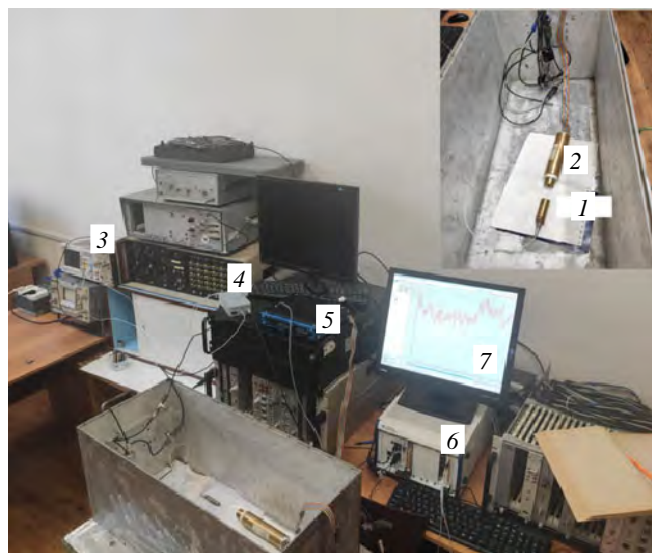
Рис. 8. Фотография стенда рентгеновского излучения для испытания CdTe-детекторов: 1 — детектор; 2 — рентгеновская трубка; 3 — блок питания для усилителя; 4 — усилитель; 5 — модуль управления рентгеновской трубкой; 6 — АЦП (NI PXIe-5105); 7 — монитор
