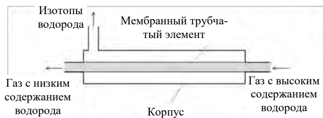
Рис. 8. Принципиальная схема системы мембранного выделения изотопов водорода из газа
