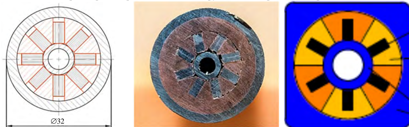
Рис. 8. Варианты конструкции обмоточного провода ТРТ типа VSS
