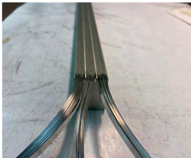
Рис. 12. Вариант КС торцевого типа с введением дополнительного медного слоя толщиной 100 мкм между ВТСП-лентами
