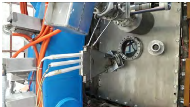
Рис. 10. Изображение рентгеновской камеры с детекторами CdTe на токамаке Т-15МД
