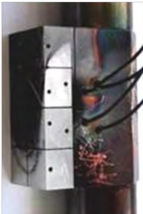
Рис. 3. Вольфрамовый модуль теплозащитной облицовки дивертора после испытаний в плазме ПЛИМ, установлены термопары для измерения тепловых потоков
