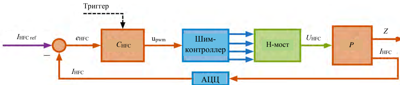
Рис. 8. Структурная схема цифровой системы управления током в НФС с инвертором напряжения в режиме ШИМ
