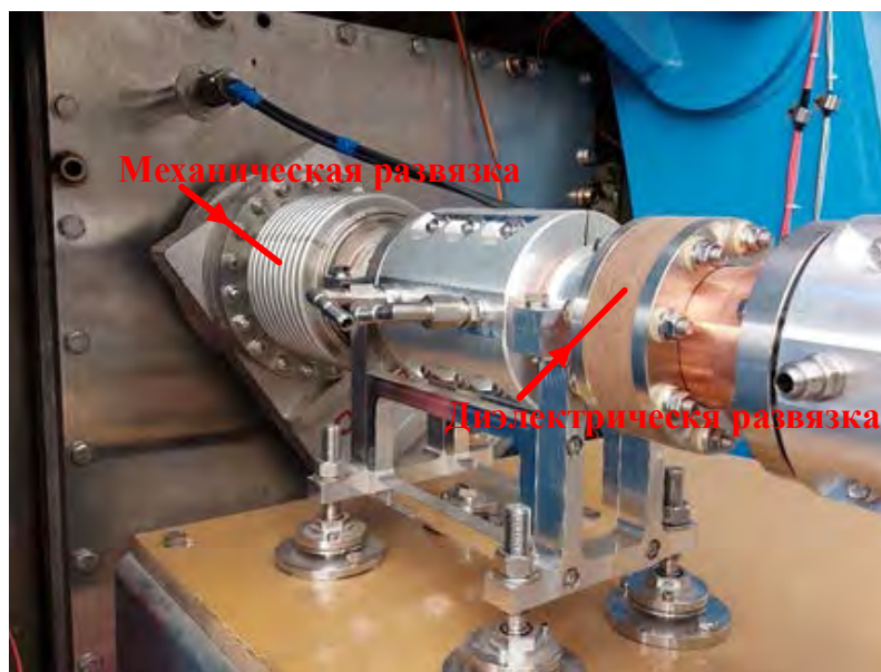
Рис. 5.4.9. Конечный участок волноводного тракта. Механическая и диэлектрическая развязки
