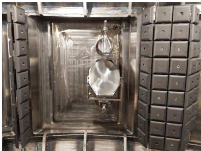
Рис. 5.4.17. Система ввода СВЧ-излучения, установленная внутри вакуумной камеры Т-15МД на стадии энергетического пуска в экспериментальных кампаниях 2023 г.
