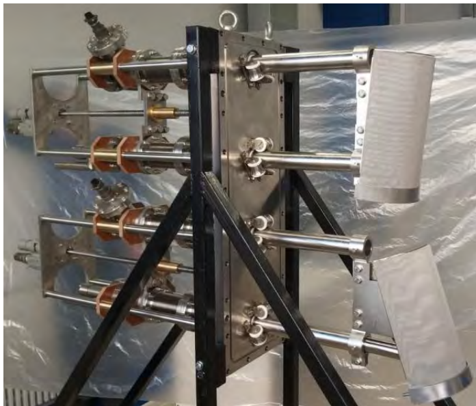
Рис. 3.4.1. Макет коллектора лития для Т-15МД
