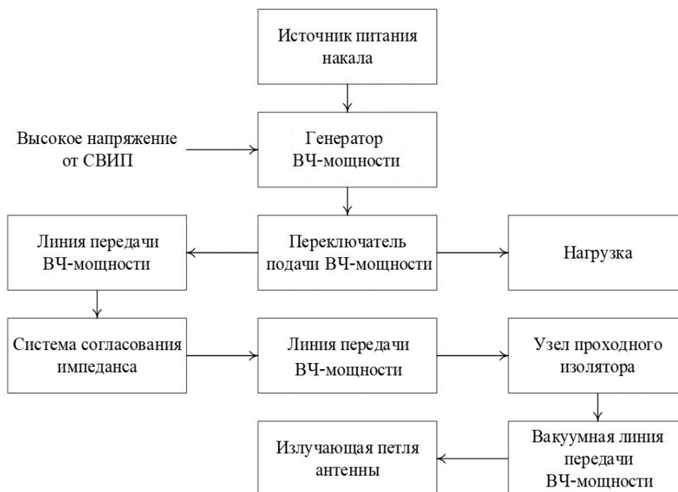
Рис. 5.2.2. Структурная схема ВЧ-канала системы ИЦР
