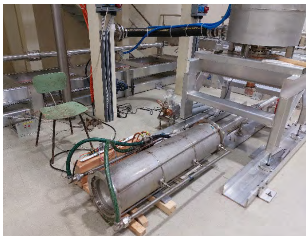
Рис. 5.4.15. Калориметрическая нагрузка в зале Т-15МД
