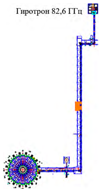
Рис. 5.4.8. Схема волноводного тракта. Общая длина линии СВЧ-передачи около 37 м
