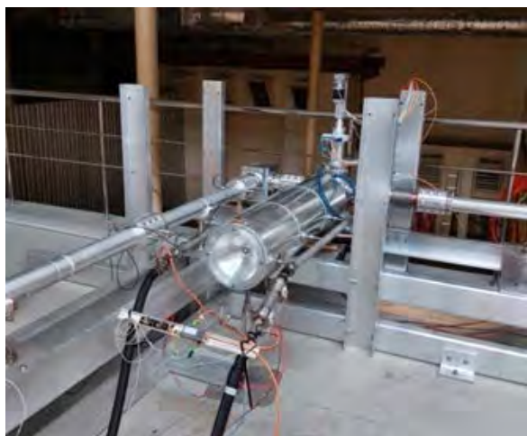
Рис. 5.4.14. Калориметрическая нагрузка, расположенная вблизи гиротрона
