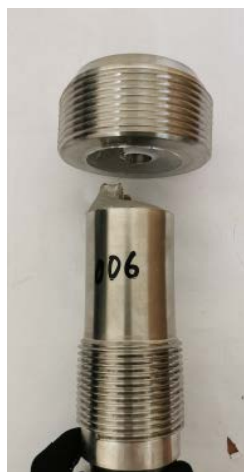
Рис. 8. Общий вид болта М64×4 ППС после испытаний на предельное усилие (этап 2)
