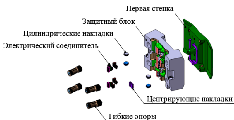
Рис. 1. Внутрикамерные компоненты ИТЭР
