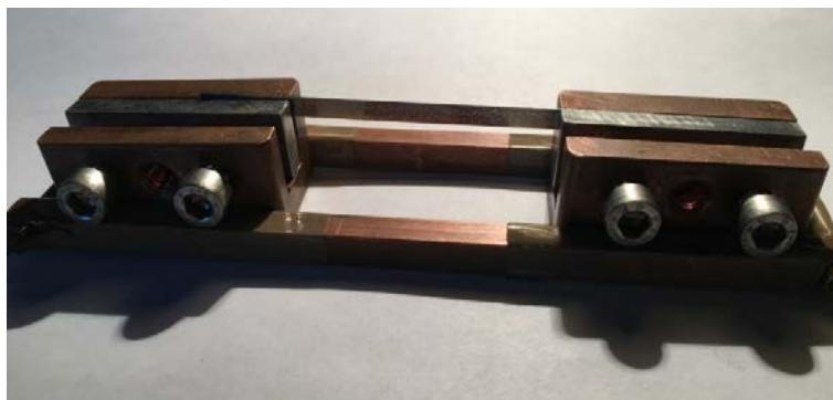
Рис. 1. Оснастка для измерения вольтамперных характеристик композитных ВТСП-2-лент с прижимными контактами
