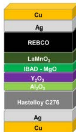
Рис. 1. Слоевая структура ВТСП-2-ленты
