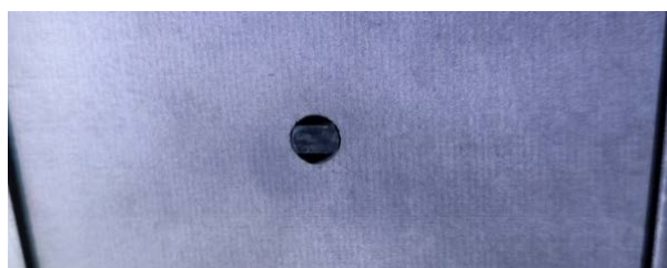
Рис. 3. Фотография диагностического винта в графитовом тайле КТМ
