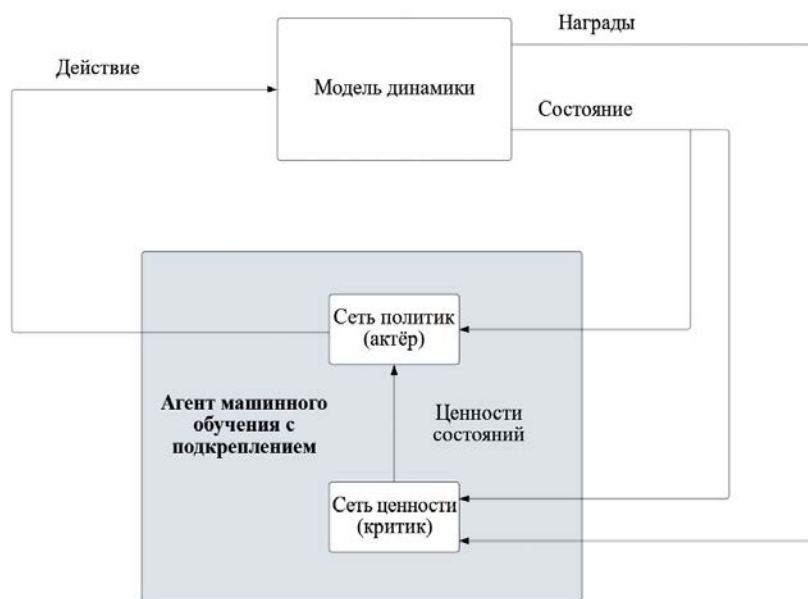
Рис. 3. Общая блок-схема метода «актёр—критик»: сеть политик — нейронная сеть, принимающая на вход текущее состояние среды и ценность полученного состояния; сеть ценности — нейронная сеть, аппроксимирующая функцию ценности, т.е. ожидаемую выгоду от состояния, поданного на вход, за оставшееся время. Иногда в качестве среды может использоваться другая нейронная сеть, часто называемая моделью динамики
