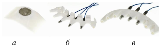
Рис. 12. Обтекатели для установки датчиков Keller (а), «гребёнка» для установки шести датчиков РСВ напротив сопла (б) и «гребёнка» для установки восьми датчиков РСВ вдоль электрода (в)
