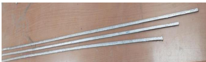
Рис. 6. Субкабели с плетённой медной оболочкой (прототип № 2)
