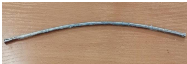
Рис. 5. Субкабель с оболочкой из отожжённой медной трубки (прототип № 1)
