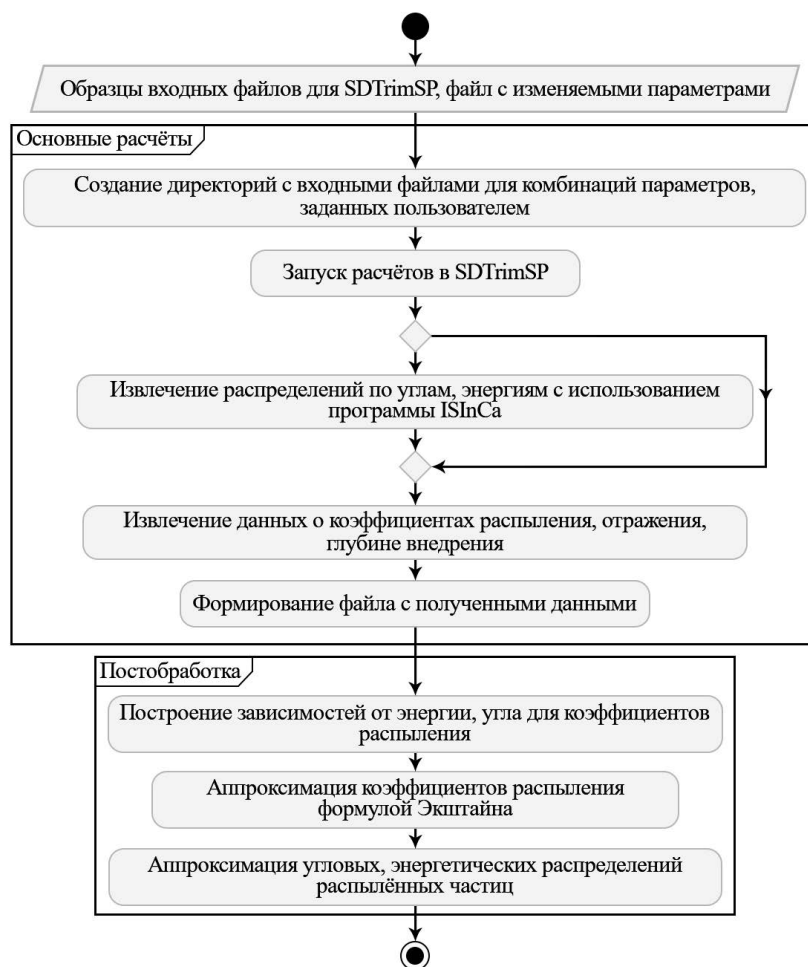
Рис. 1. Диаграмма активности (блок-схема) работы БК для массовых вычислений с помощью SDTrimSP
