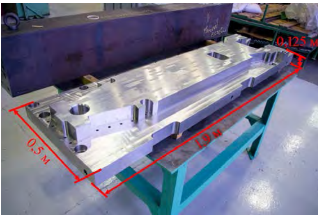
Рис. 7. Промежуточный этап производства квалификационного образца операций глубокого сверления, выполненного из стали 316L(N)-IG
