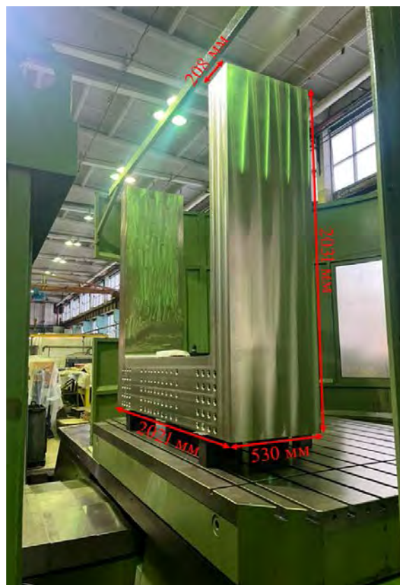
Рис. 4. Заготовка ДЗМ № 2 экваториального порта № 11, изготовленная из цельной поковки из стали 316L(N)-IG
