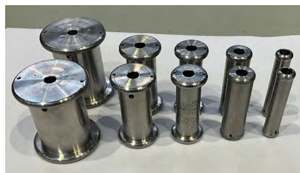
Рис. 11. Оптические калибры с диаметрами 40, 25, 20, 15, 10 мм
